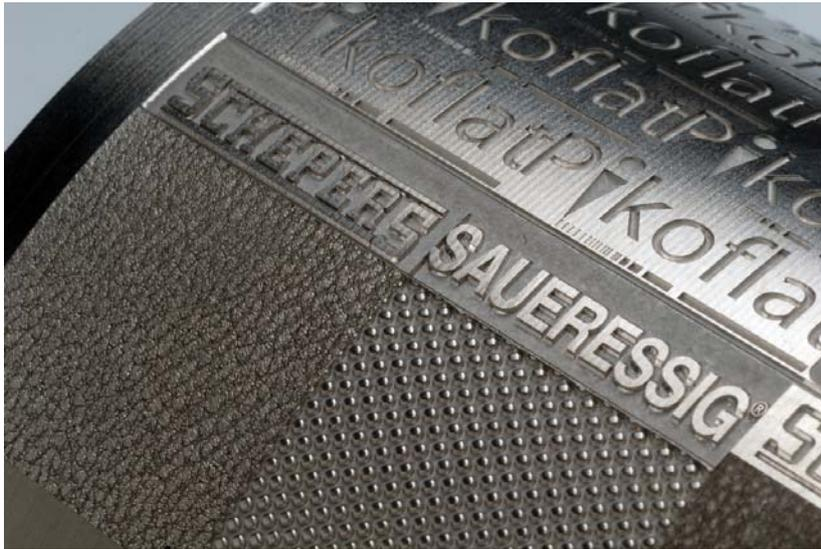
Bild 1: Kalotte und bearbeitetes Leder einer mit Pikosekunden-Laser dreidimensional strukturierten Prägwalze
